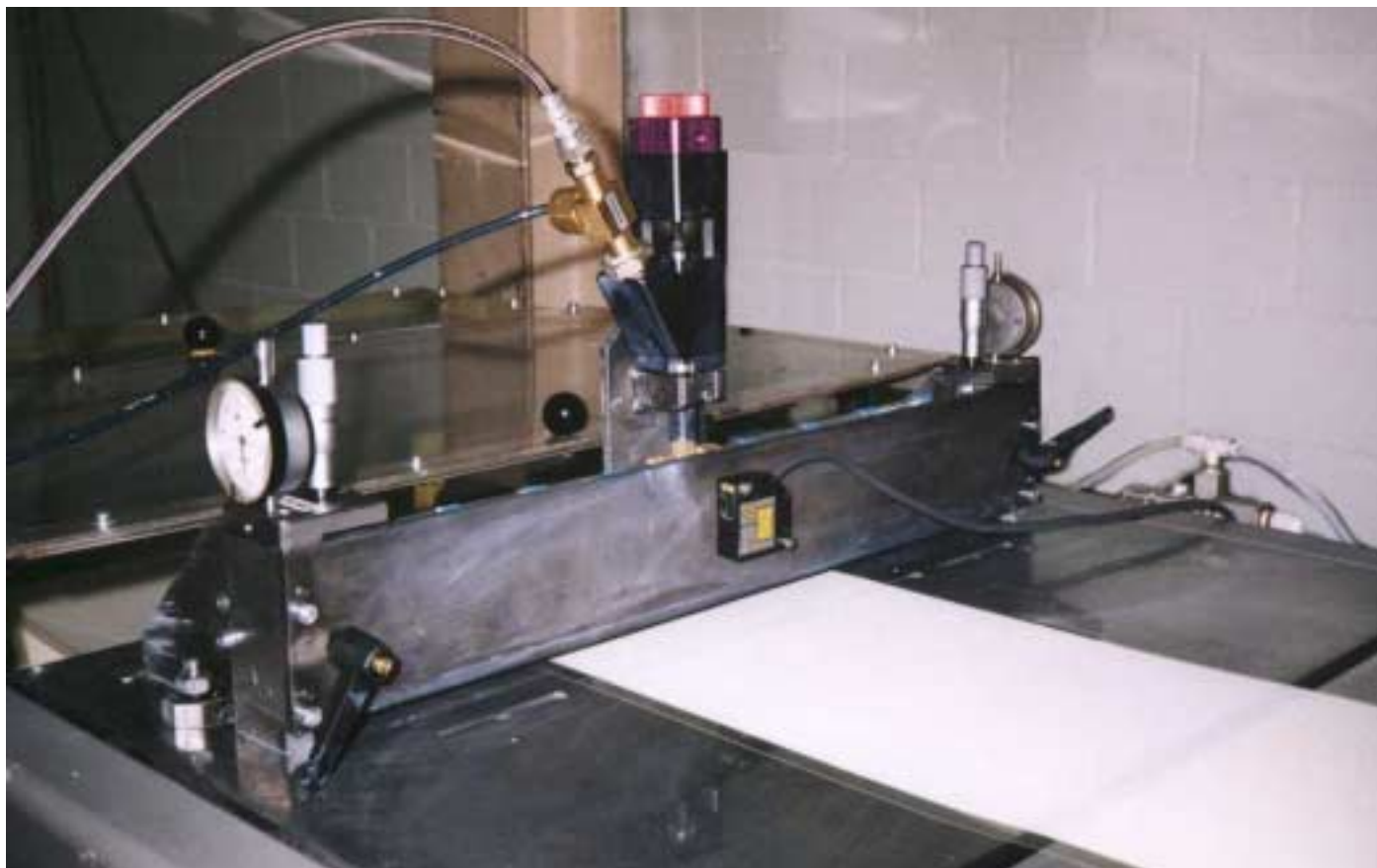
Tête de dépose avec des vis micromètres pour ajuster l'épaisseur d'application de la matière.
