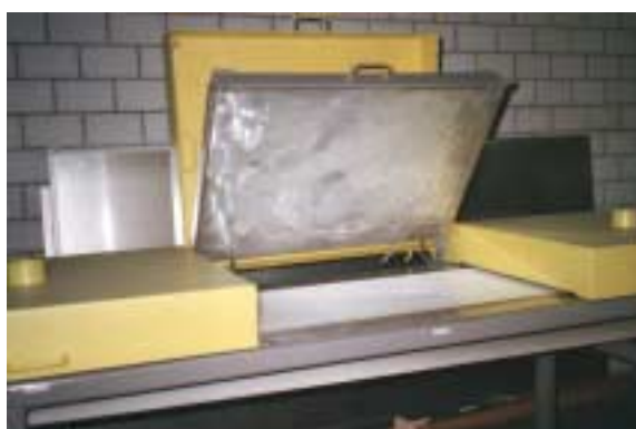
Vue dans une zone de chauffage La plaque chauffée est garde en position ouvert par deux ressorts à gaz
