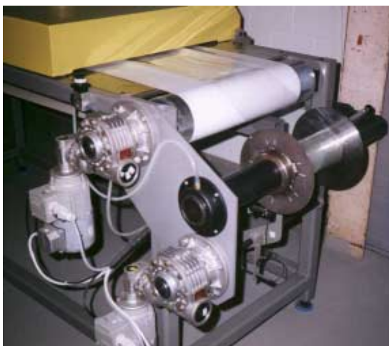
Tête de dépose avec des vis micromètres pour ajuster l'épaisseur d'application de la matière.
