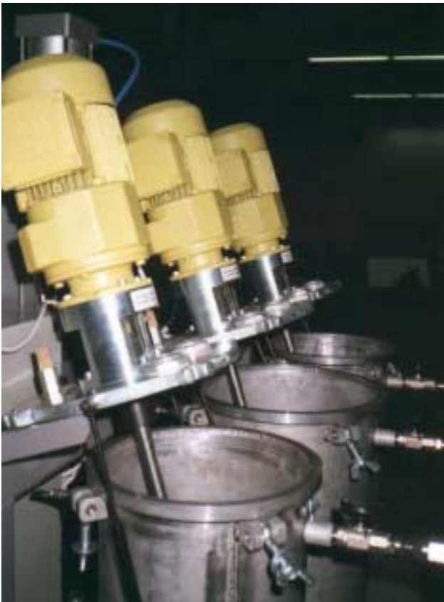
Les remueurs en position ouverte pour remplir les réservoirs.
