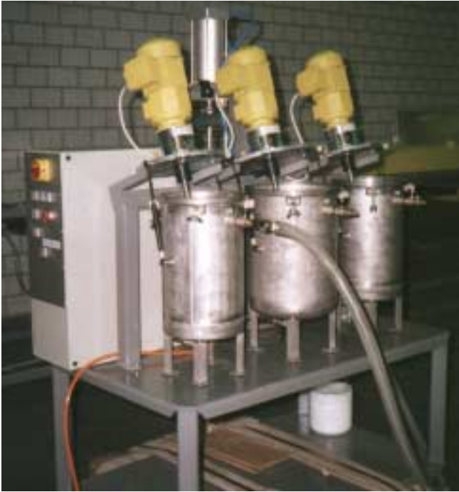
Les remueurs en position ouverte pour remplir les réservoirs.
