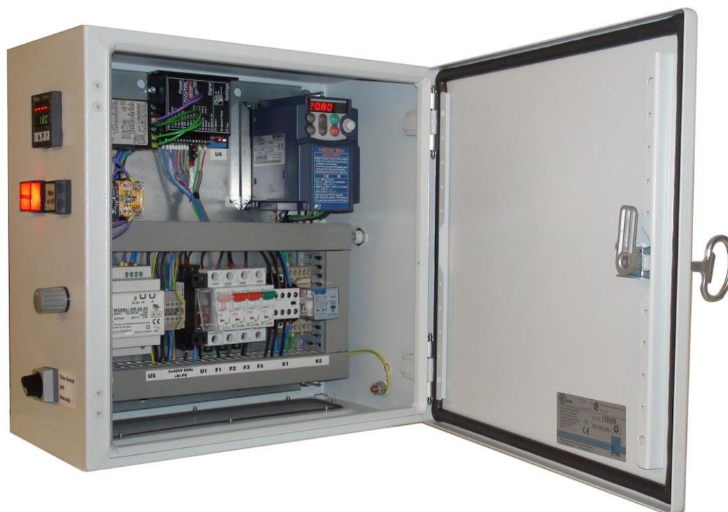
Commande électrique pour encolleuse avec rouleau d'appuis
