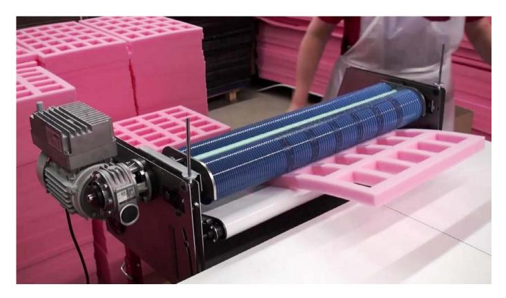
Gegenüber dem herkömmlichen verarbeiten von Kaltleim mittels sprühen hat der Walzenauftrag folgende **Vorteile**:
